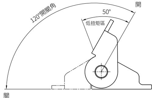
上圖顯示K-TD89A1B1的阻尼器作動角度，出廠時軸的位置是關閉狀態
