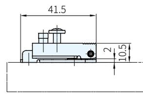
※內置規格時，H尺寸為門厚+17mm，但GS-H160型，GS-170型的內置規格為門厚+12mm
