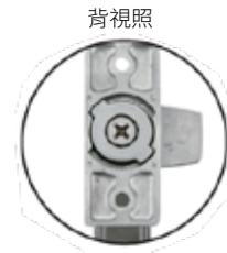
· 變換主體後方止動片方向，可改變把手開啟方向，左右共用
