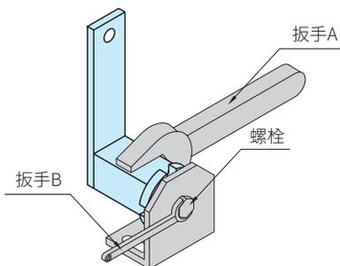
扳手A可調整本體迴轉到必要角度後，以扳手B將螺栓固定在本體
