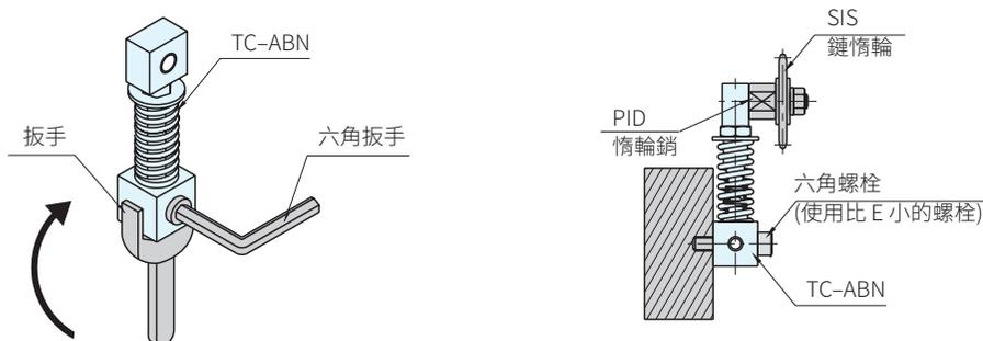
以扳手作角度調整，在附加張力狀態下，以扳手裝其固定在本體上
