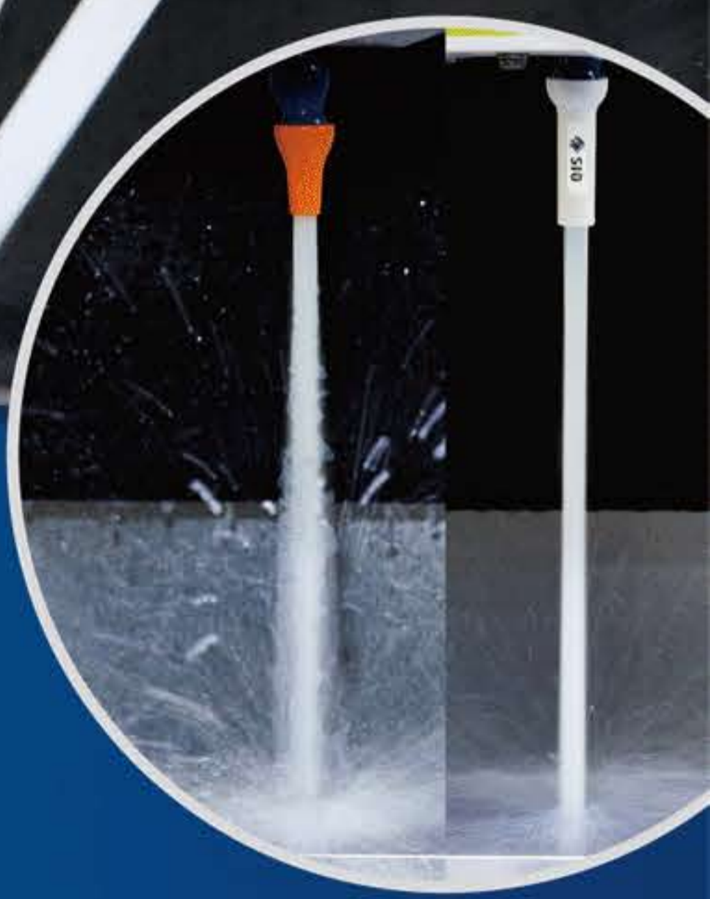
左：一般冷卻劑噴嘴 右：RECTIFIER噴出的直線形加工液
